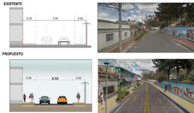
Imagen perfil existente y propuesto de la Carrera 5, anillo perimetral Fuente Contrato IDU 1514-2017
